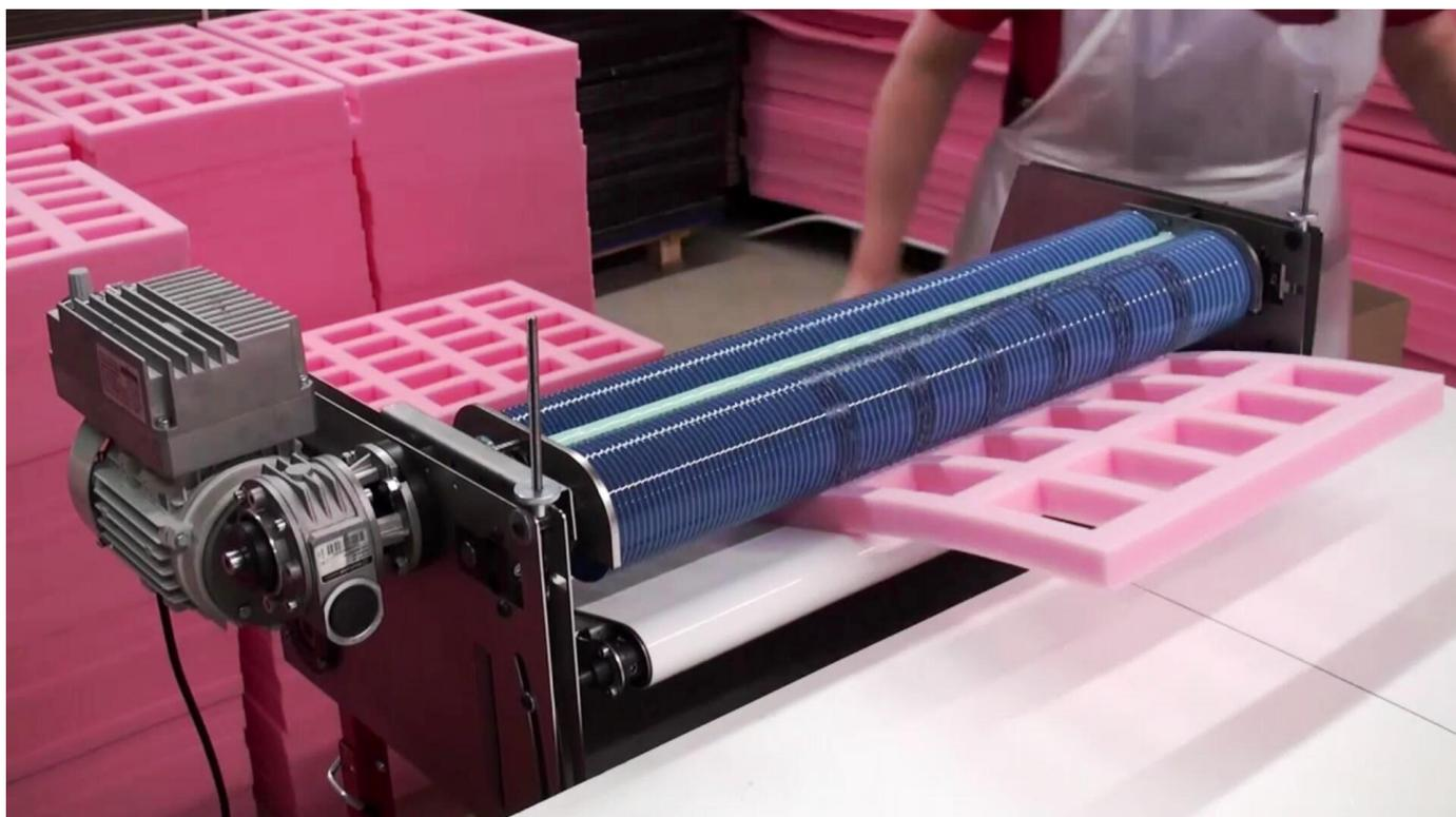
Au lieu de vaporiser la colle froide sur les pièces de mousse, l'application de la colle par une encolleuse à rouleau a les avantages suivants:
