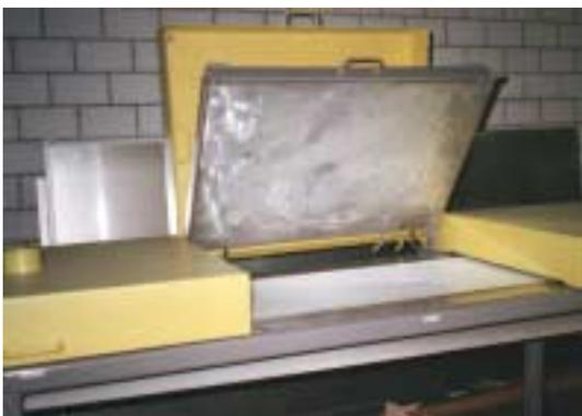
Ansicht Heizzelle. Die Heizplatten werden mit Gasdruckfedern im geöffneten Zustand gehalten.
